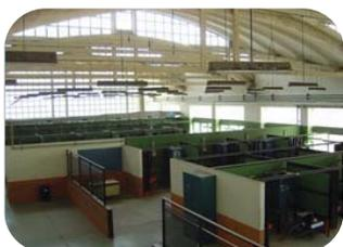
*En este espacio se ubicaban puestos de soldadura oxiacetilénica, cabinas de soldadura eléctrica, especiales en atmósfera de gas inerte y puestos de arco sumergido, submarina...*
