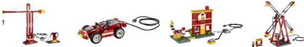
Para dar movimiento a sus creaciones se basarán en unos sensores simples y en un motor, que se conecta al ordenador mediante Hub USB LEGO. El entorno de programación está basado en iconos, que simplemente se arrastran para colocarlos y que quedan enganchados como un puzle, por lo que no requiere una experiencia previa determinada. Este software detecta los sensores y motores y permite programar las diferentes opciones.
