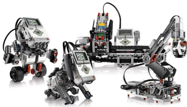
Los participantes con conocimientos pueden continuar con **LEGO Mindstorm**, con el que construir sus primeros robots valiéndose de piezas de LEGO, motores, una placa que hace las funciones de “cerebro” y sensores de luz, sonido, ultrasonido y tacto.
